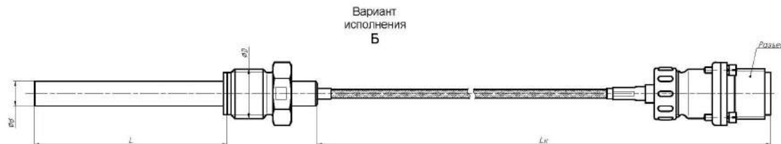
Рисунок Г.9 - Общий вид ТС.К без головки (варианты исполнения защитного корпуса см. табл. Г.3)
